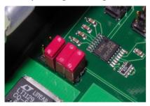
For dual wire format remove the Ist jumper:
