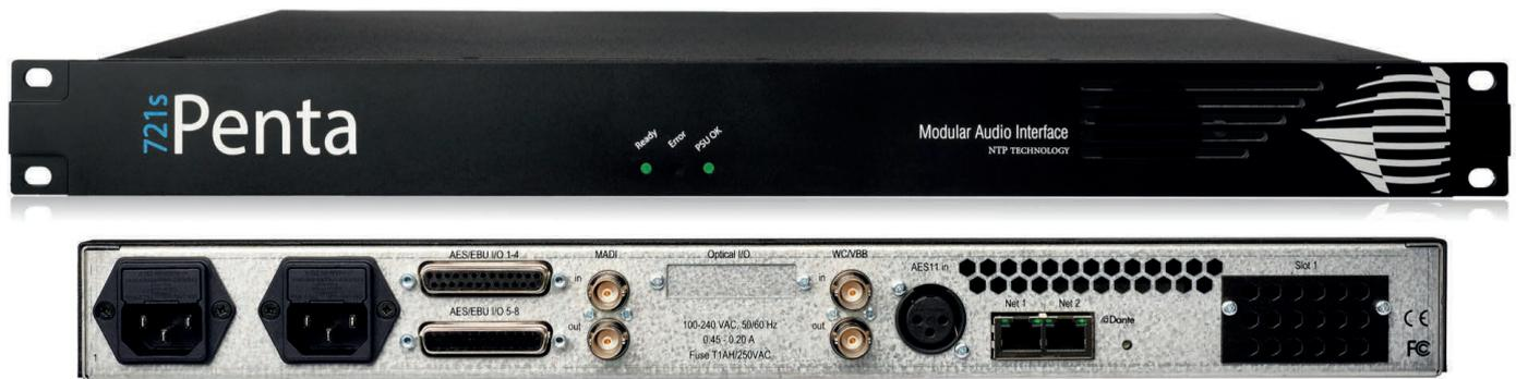
Penta 751S est une unité de routage AES, MADI et DANTE, dotée d'un emplacement pour carte d'extension optionnelle. Polyvalent et modulable, il offre des solutions fiables de distribution et de routage audio via AES/EBU, MADI et réseau Gigabit Ethernet ou fibre optique. Le slot d'extension est adapté à toutes les cartes d'extension Penta disponibles.
