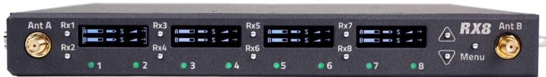
Le MicPlexer intégré au RX-8 permet une amplification de +3dB au signal RF reçu avant sa distribution aux MRX enfilés, et ce de 512 à 698 MHz, permettant une réception robuste sur une bande passante étendue.
