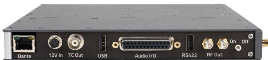
Un connecteur DB25 permet la sortie de 8 canaux en analogique ou en AES3. Le port RS422 permet de distribuer la commande ZaxNet (via un TRXCL4 ou un IFB300).
