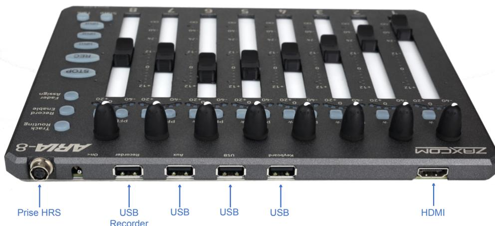
Alimentée par une prise HRS (150 mA @ 12V), l'Aria-8 se présente également comme un véritable hub USB : une prise USB est dédiée à l'enregistreur et les trois autres prises USB vous permettront de brancher un clavier sans fil et d'alimenter vos appareils USB ! Un connecteur HDMI est intégré pour ajouter l'extension Aria-4.
