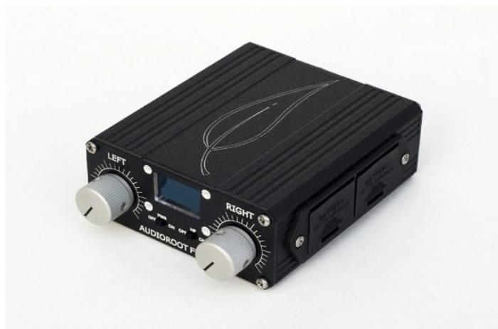
L' AUDIOROOT FEMTO est un préamplificateur portable auto alimenté de grande qualité conçu pour l'enregistrement de terrain (musique, cinéma et documentaire). Il combine pour un prix réduit une électronique de pré-amplification à faible bruit avec une alimentation phantom, un coupe-bas 80hz 12dB/oct ainsi qu'un superbe petit écran OLED pour l'affichage du niveau audio et du niveau de pile.
